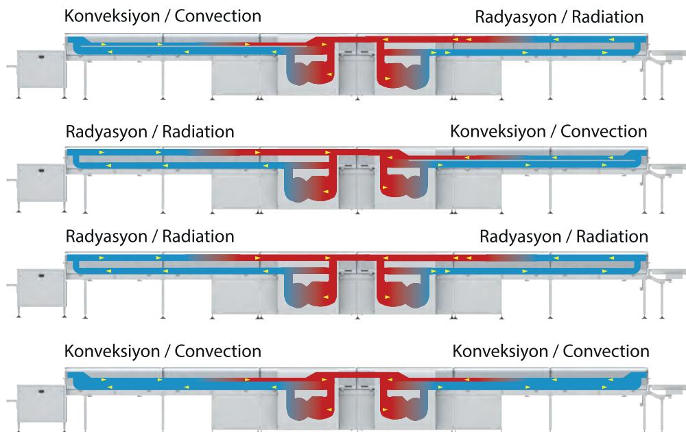
Ürünlerin tabanı temas ile soğutulurken, üst soğutmayı ister konveksiyon ister radyasyon yöntemi ile yapabilirsiniz. Hassas sıcaklık kontrol sistemi ve ısı dağılımı sayesinde elde edebileceğiniz en parlak ve uzun ömürlü kaplamaya sahip olursunuz.
